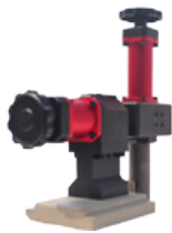
内坡口刀架 该刀架可外坡口、内坡口、开法兰槽及简单法兰修复，该刀架作业于有特殊要求的现场，该设备可满足现场坡口角度。
